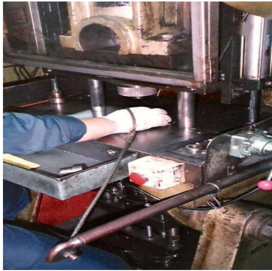
圖二十二 手拉回式與連桿掃除式防護裝置
