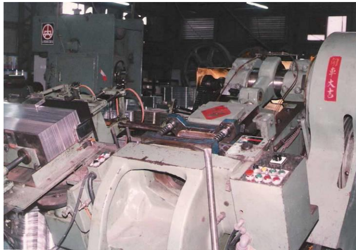
圖二十六 利用吸盤方式橫向供料
