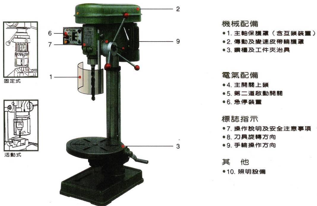
圖十六 安全防護配備
