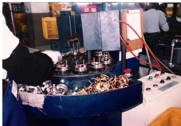
圖二十七 利用轉盤方式橫向供料
